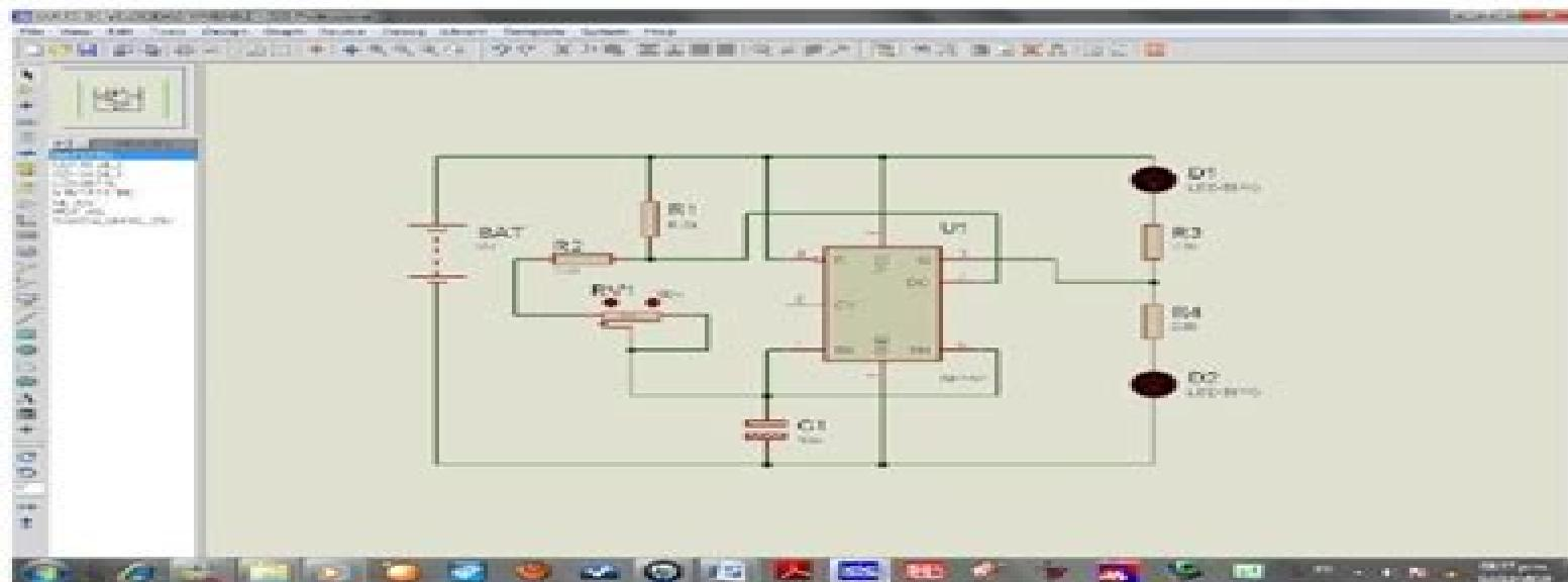
2. Cuando estemos seguros de que hemos terminado nuestro circuito y estamos listos para diseñar la placa debemos adicionar elementos como borneras, conectores o demás componentes que
