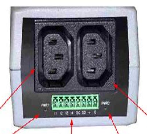
Розетка для подключения нагрузки (1 канал) Светодиод индикации напряжения 2208 1 канал
