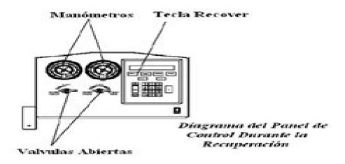
7. Si la presión en el sistema está por debajo de 25 psi se muestra un mensaje en pantalla que dice "LOW SYSTEM PRESSURE" (Baja presión en el sistema), hasta que la presión se incremente o la tecla "START" sea presionada. Se puede presionar la tecla "STOP" si se desea salir del proceso de recuperación en este punto.
